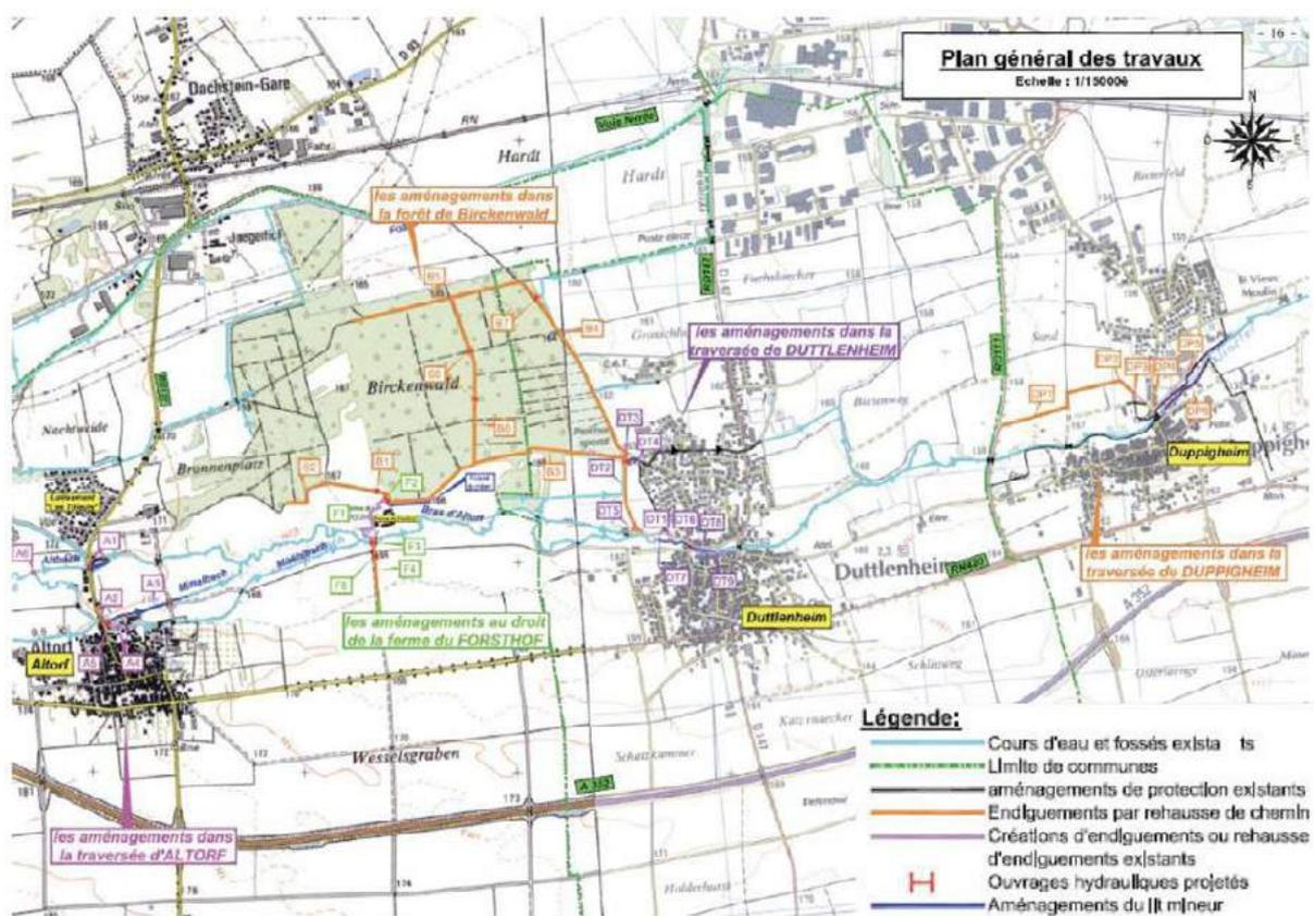
Figure 22 : Aménagements du bras d'Altorf et du polder de Birkenwald intégrés au modèle hydraulique
