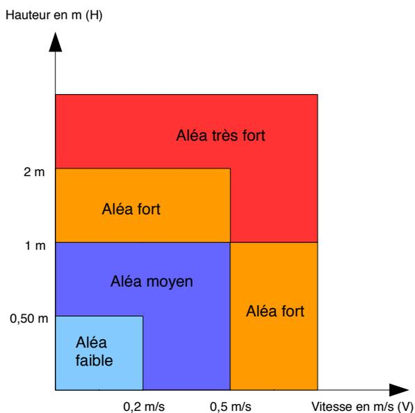
Figure 23 : Représentation graphique des aléas selon les hauteurs d'eau et les vitesses d'écoulement.
