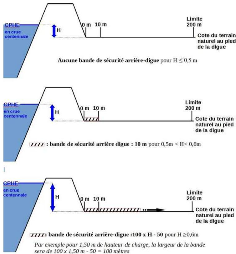
Figure 25 : Délimitation des bandes de sécurité arrière-digue.
