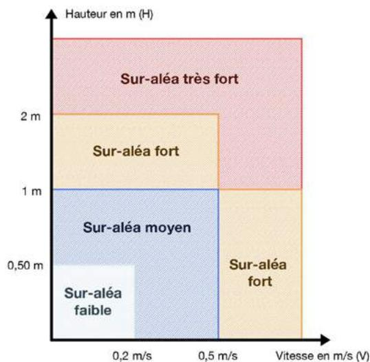
Figure 24 : Représentation graphique du sur-aléa issu de la défaillance de l'ouvrage du Birkenwald selon les hauteurs d'eau et les vitesses d'écoulement.
