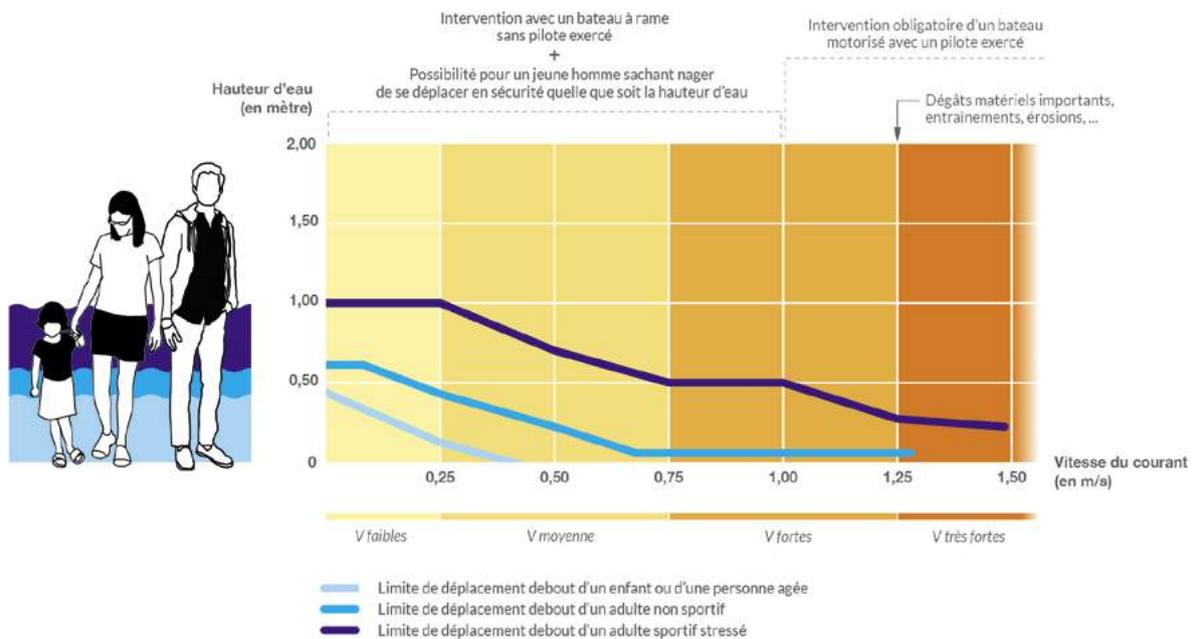
Figure 4 : Tableau de la capacité physique des personnes à se déplacer dans l'eau.
